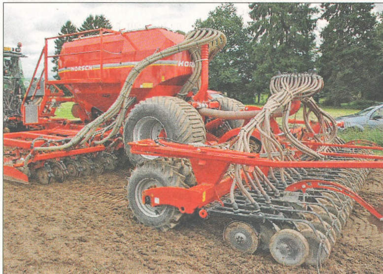
Ce semoir Horsch Pronto est utilisé pour différentes applications: semis de céréales avec application d'engrais, semis de mélanges fourragers, sursemis de prairies...
